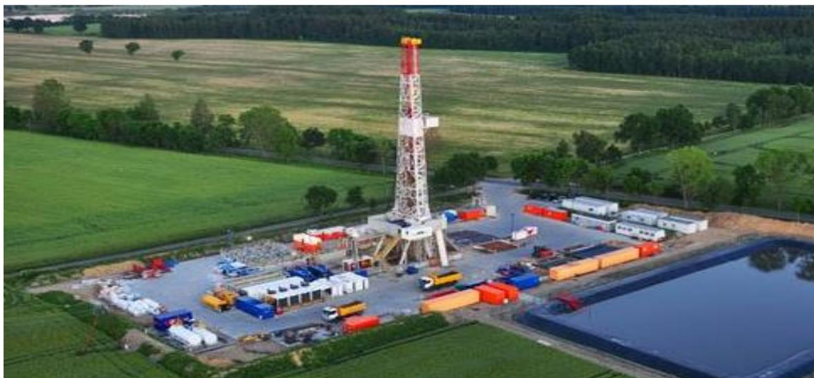
中石油西南油气田公司通过探索出一套页岩气规模效益开发方法,包括页岩气综合地质评价技术、水平井体积压裂技术、水平井组工厂化作业技术、地面采输技术等积累了地质工程一体化、高产井培育等页岩气规模效益开发先进经验;初步建成长宁-威远国家级页岩气示范区等,培育了一批高产井。采用“工厂化”作业平台的开发模式,页岩气单井钻井成本由 1.3 亿元缩减至 5000 万元,为页岩气的大规模开发和商业打好了坚实的基础。在未来几十年里通过技术创新降低开采成本后,丰富的储量使得中国页岩气产量最终将超过美国,也将会改变世界第一大能源消耗国中国的能源供给格局。
